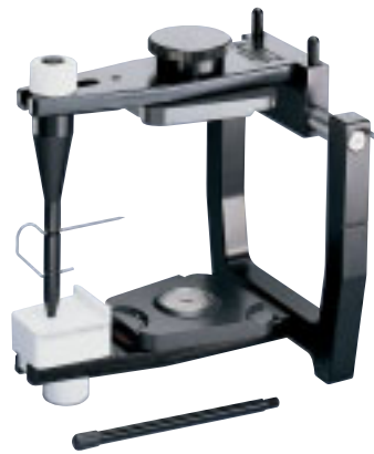
La mesa de transferencia transmite las informaciones del arco facial al articulador Artex. Transmisión de datos entre clínica odontológica y laboratorio.
