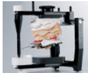
La mesa de transferencia transmite las informaciones del arco facial al articulador Artex. Transmisión de datos entre clínica odontológica y laboratorio.
